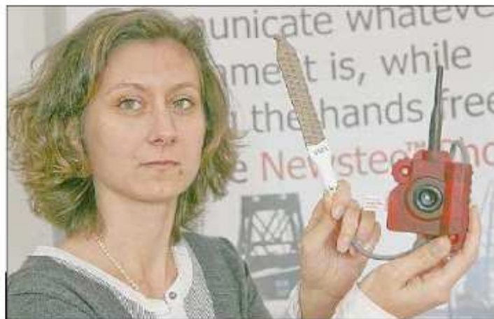
Un capteur de température pour surveiller la prise du béton.
