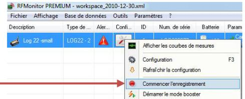
**Attendre une transmission radio** ou **passer un coup d’aimant** sur le Logger pour que les modifications soient prises en compte par le Logger. La campagne de mesure commence; le Logger enregistre maintenant toutes ses mesures en mémoire et envoie chaque minute un signal de présence pour indiquer son état, les dépassements d’alerte et le nombre de mesures en mémoire.
