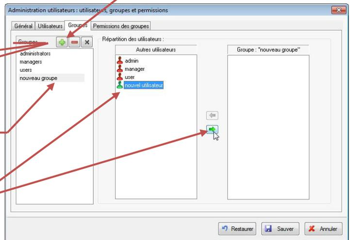
Pour **supprimer un utilisateur** dans un groupe, **sélectionner le dans la colonne Groupe** et **cliquer sur la flèche verte vers la gauche**.
