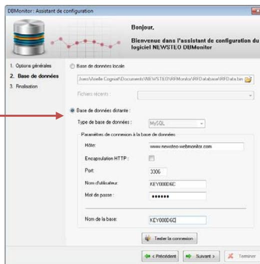
Cliquer sur **Tester la connexion** puis valider la fenêtre « Tester la connexion »
