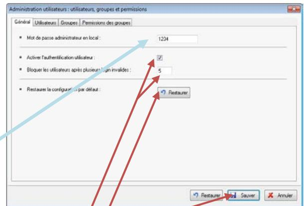
En cochant **Activer l'authentification utilisateur**, chaque utilisateur **devra s'authentifier** et taper son mot de passe (créé dans la fenêtre Utilisateurs) **pour ouvrir RF Monitor** avec un **nombre d'essai limité** à la valeur définie dans le champ **Bloquer les utilisateurs après plusieurs login invalides**
