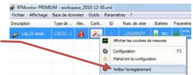
**Attendre une transmission radio** ou **passer un coup d’aimant** sur le Logger pour que les modifications soient prises en compte par le Logger. (Le nombre de mesures en mémoire est affiché dans la colonne « mesures » de la ligne du Logger)
