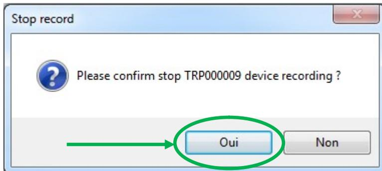
Das Gerät läuft aktuell im 'Record-Modus'; der Befehl wird erst bei der nächsten Funkkommunikation ausgeführt (jede volle Minute).
