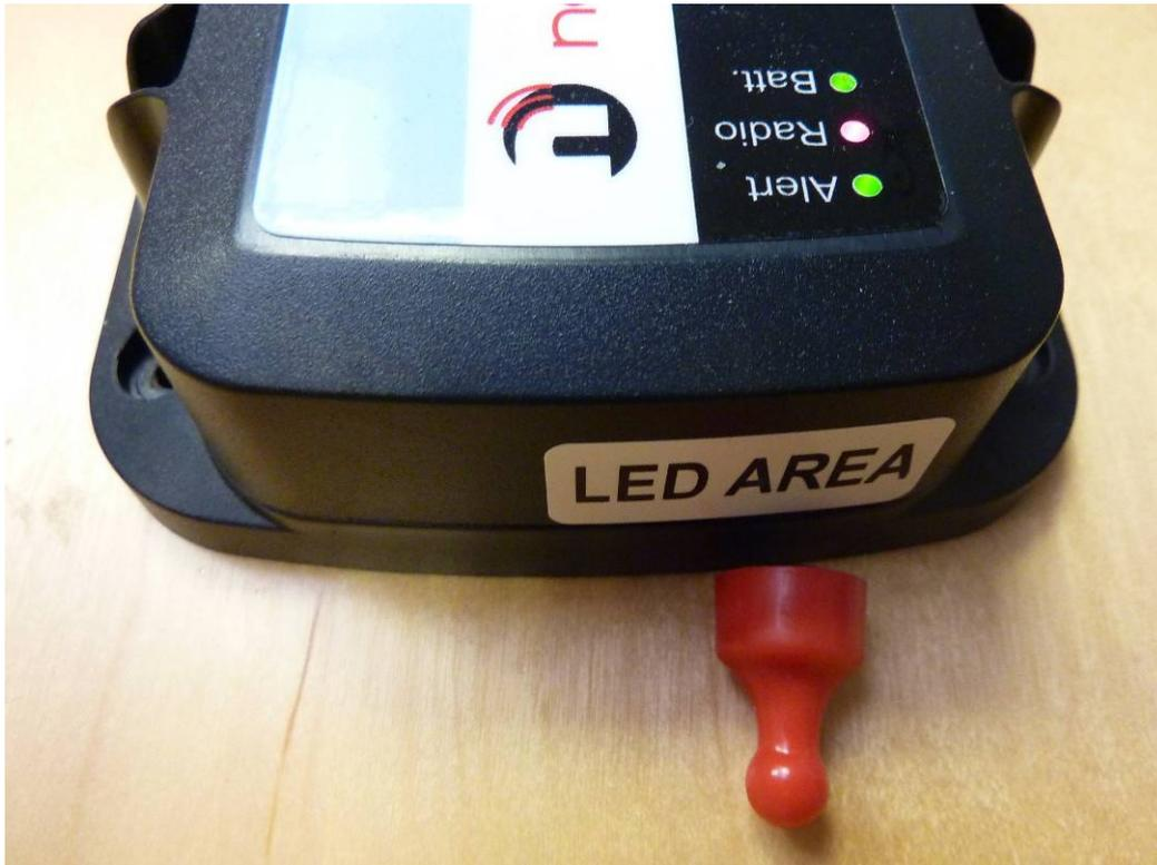
Eine Aufnahme starten bedeutet, dass der TRP55 sich im **‘Tiefschlafmodus befindet’**; deshalb sind alle LEDs normalerweise aus, wenn der Magnet an dem LED AREA Etikett platziert wird.
