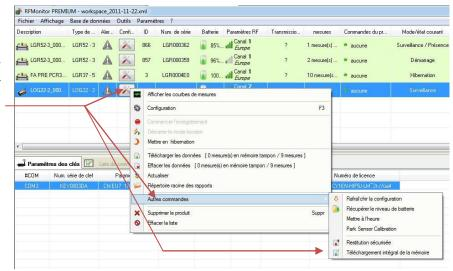
Le téléchargement commencera à la prochaine transmission radio (dépend de la période configurée pour le produit) et pourra prendre jusqu'à 15 minutes.
