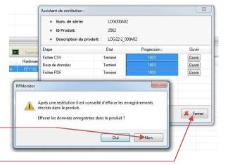
A la fin du téléchargement, il n'est pas nécessaire d'effacer la mémoire du logger.
