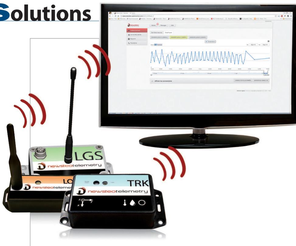
Au lieu de stocker des photographies, les industriels sauvegardent des données de température, d'humidité relative, etc. et disposent d'un accès facile pour leur consultation : un PC, une tablette numérique ou un smartphone permet de recevoir une alerte, en cas de dépassement de seuils, et de consulter une courbe de températures.
