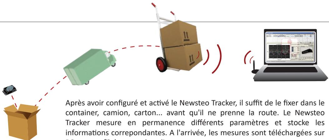
Après avoir configuré et activé le Newsteo Tracker, il suffit de le fixer dans le container, camion, carton... avant qu'il ne prenne la route. Le Newsteo Tracker mesure en permanence différents paramètres et stocke les informations correspondantes. A l'arrivée, les mesures sont téléchargées sur PC en sans fil, à travers le colis.
