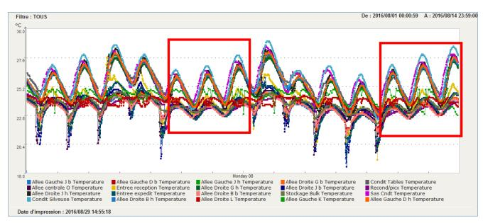
D'après le graphique, nous pouvons conclure que toutes les mesures de températures relevées sont dans la bonne plage de mesure +5°C/+30°C. On peut voir l'ouverture des portes lorsqu'il y a des pics bas ou hauts de température. En effet, quand les portes sont ouvertes, l'air est renouvelé et il est plus frais que celui de l'entrepôt le matin, et plus chaud l'après-midi.
