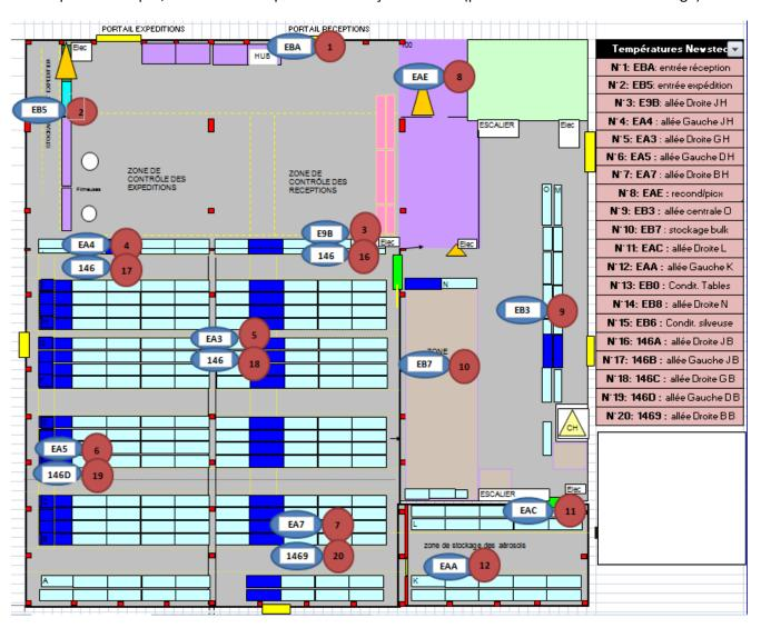
Pour l'étage, (partie conditionnement) les sondes sont placées de la façon suivante :
