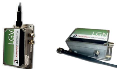
El LGN45 para inclinómetro y CTN, con sensor alimentado por el registrador transmisor Newsteo.
