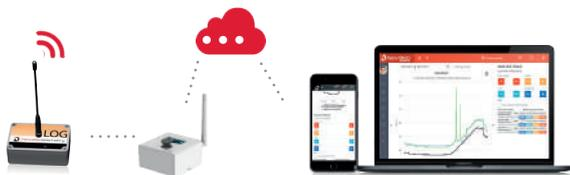
L'enregistreur radio transmet les mesures à la gateway qui les stocke dans le cloud. Grâce à l'application web **WebMonitor** accédez à vos mesures n'importe où, à partir d'un PC, smartphone, ou tablette.
