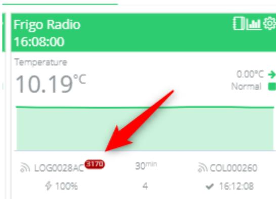
3. Si le widget est en vert et que la date de la dernière mesure n'est pas à jour, c'est que le logger n'arrive pas à transmettre ses mesures au CUB même si le CUB et le logger arrivent à communiquer. La transmission est trop faible pour que le logger arrive à
