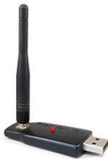
4. Das GAT-Gerät, die Logger und der RF-USB Schlüssel müssen auf dem gleichen Funkkanal eingestellt sein (das GAT und der USB-Schlüssel werden von uns auf Kanal 1 voreingestellt geliefert)
