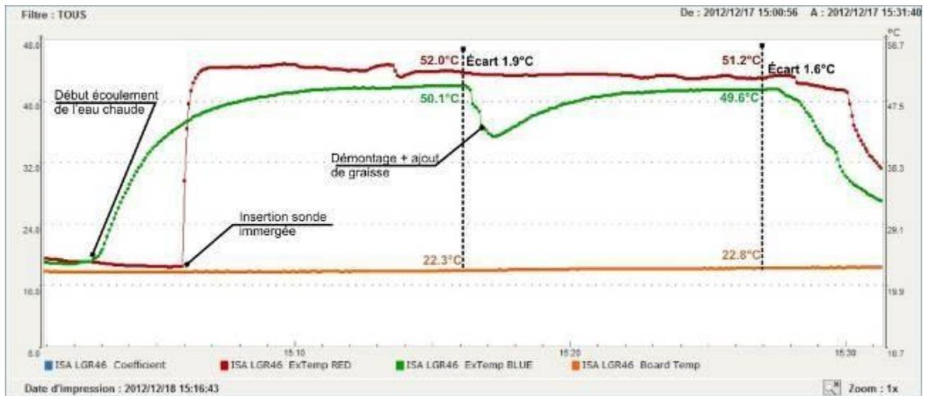
Abweichung zwischen Rohrsonde und eingetauchte Sonde:
