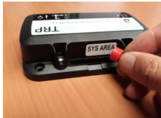
Wenn das Gerät sich in *Tiefschlaf-Modus befindet*, sind normalerweise alle LEDs aus, wenn der Magnet in Nähe der *LED AREA* platziert wird.
