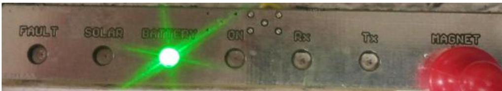
« **FAULT** », quand il est éteint : aucune faute détectée ; quand il est rouge fixe : indique un défaut de fonctionnement de la carte, ou la présence d'eau dans le boîtier.
