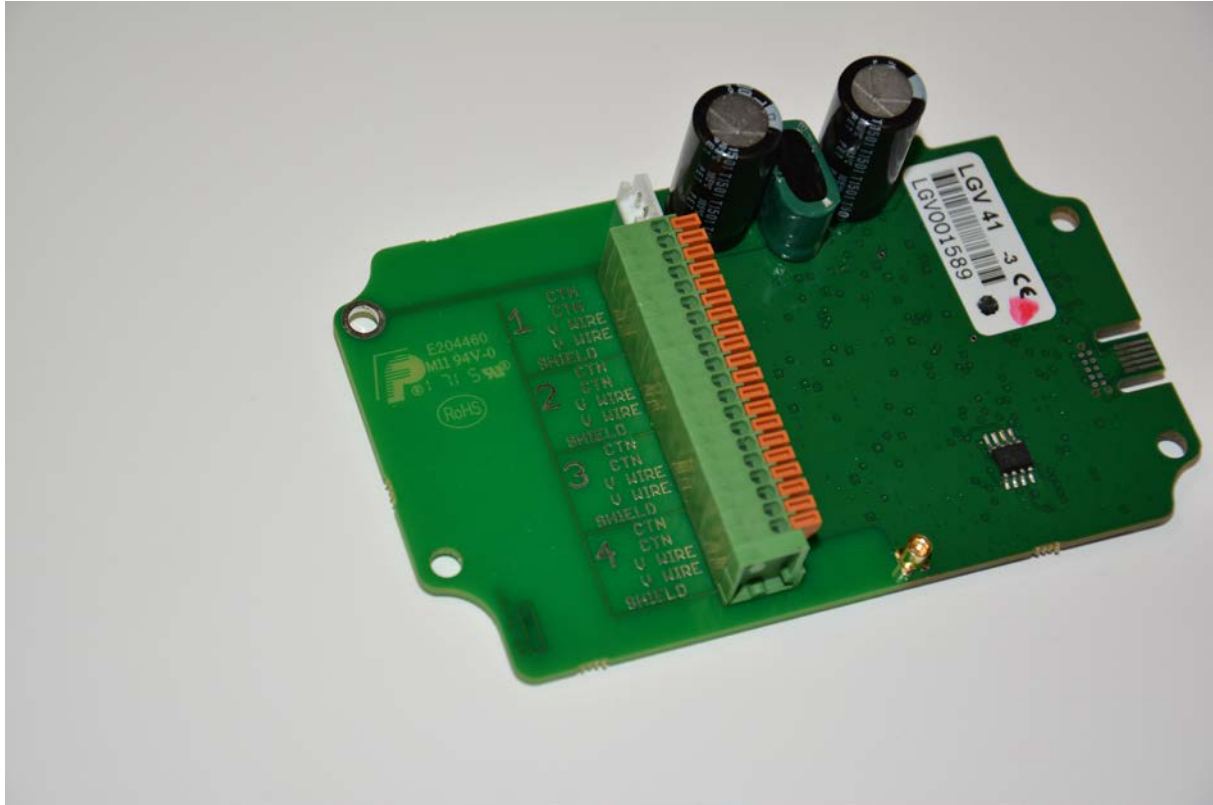
Figure 2: Connexion des cordes vibrantes
