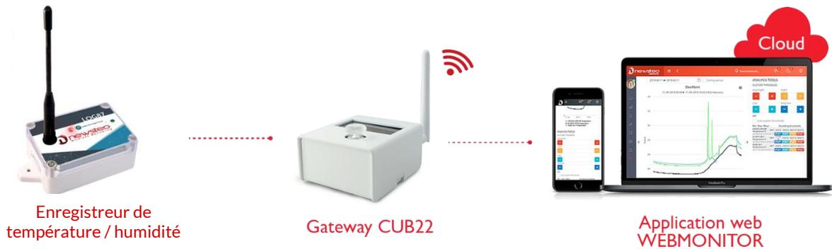
Figure 2: Fonctionnement en mode Cloud
